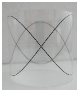
Obr. 8 Lissajousova křivka poměr frekvencí 2:3
