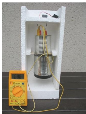
Obr. 3 a) ionizační komora (dolní plechovka je vlastní komora, horní slouží jako stínění pro zabudovaný obvod), b) schéma zapojení
