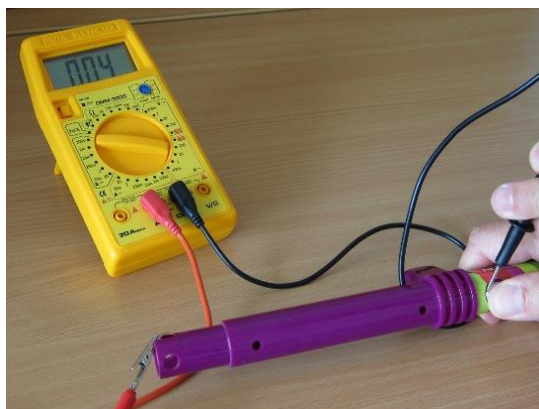
Obr. 6 Měření proudu, který magická hůlka dodává. (Na fotografii není vidět desetinná tečka před poslední číslicí; údaj je 0,4 \mu\text{A} .)
