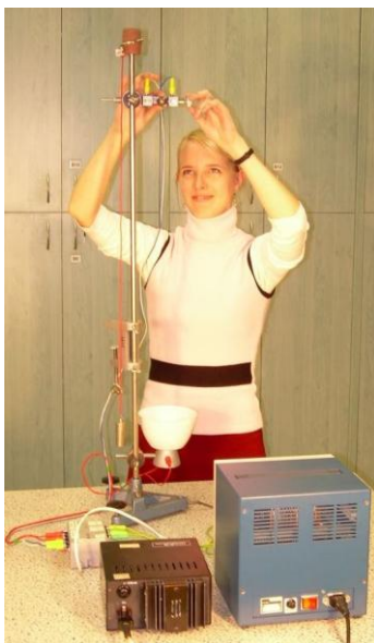
Obr. 5 Příprava na Fyzikální jarmark v Olomouci – kuličkový padostroj s příslušenstvím pro přímé měření tíhového zrychlení (dle doc. Žouželky)
