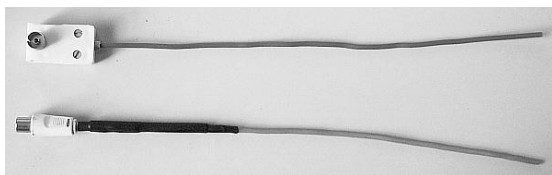
Obr. 4 Prutové antény vysílače (horní) a přijímače (dolní)
