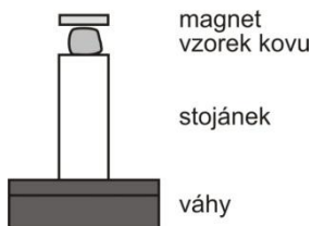
Obr. 1 Schéma demonstrace dia- a paramagnetismu
