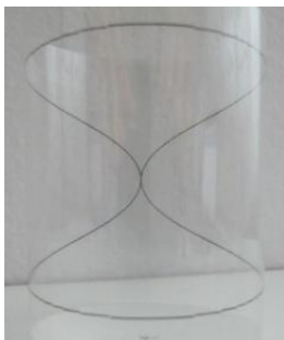
Obr. 7 Lissajousova křivka poměr frekvencí 2:1
