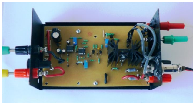
Obr. 2 Silový spínač, který umožňuje regulovat otáčky oběhového čerpadla
