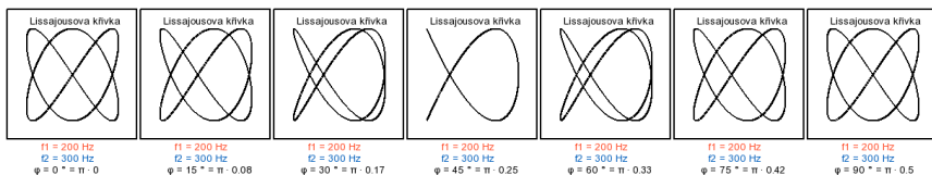
Obr. 2 Lissajousovy obrazce v poměru frekvencí 2:3, a změnou fáze po 15^\circ
