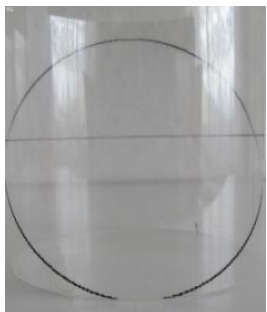
Obr. 6 Lissajousova křivka poměr frekvencí 1:1 pro fázový posun 90^\circ
