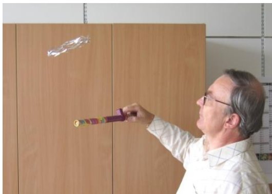
Obr. 2 Nabíty konec hůlky odpuzuje kroužek z fólie, který předtím hůlka nabíla
