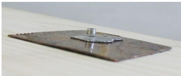
Obr. 5 Uspořádání experimentu a detail vznášejícího se magnetu
