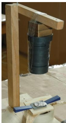
Obr. 5 Uspořádání experimentu a detail vznášejícího se magnetu
