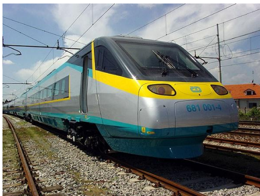
Obr. 4 Sedmi vozová jednotka Pendolino ř. 680 se skládá ze čtyř hnacích vozů a tří vozů vložených. Celkem nabízí 333 míst pro cestující. Celková hmotnost soupravy je 385 tun a celková délka soupravy je 185 metrů [4]
