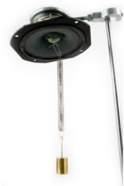
Obr. 5 Reprodaktor, pružina a závaží – při rezonanci dochází k max. vybuzení
