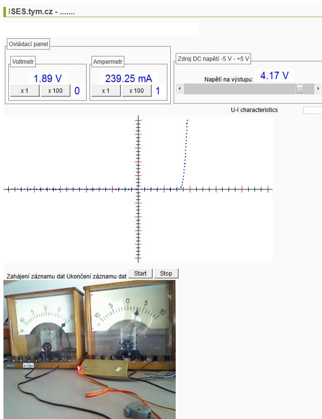
Obr. 1 Webové rozhraní vzdáleného experimentu měření V-A charakteristiky diody
